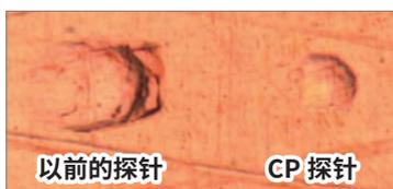
通过独立研发的探针，在不降低速度检查的前提下，使针痕最小化。
