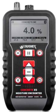
Tramex混凝土含水率测定仪CMEX5是一种非破坏性的数字多重温度计，用于混凝土地板和楼板，以重力测试为基线，提供即时和精确的水分含量定量测量。CMEX5还提供了混凝土和其他胶结基底的碳化物法等量读数，以及根据ASTM F2659提供的比较读数。根据ASTM F2170，采用可选的Hygro-i2®相对湿度探头测试和重型针式木材探头，这种温度计可以转换为地板专业人员理想的一体化仪器。
