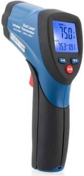
IRT2是一种手持式、双激光器、非接触式红外测温仪，具有12:1的距离与光点比和可听和可见的高/低设定报警。它用于测量和显示-50°C至650°C (-58 °F至1202 °F) 范围内的表面温度，其精度约为1至1.5% (详见规范)。IRT2具有快速响应时间 (0.15秒)，采用9V电池供电，符合II级英国/欧盟激光安全标准EN60285。
