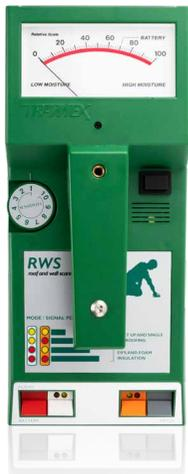
Tramex RWS渗漏巡检仪是一种多模式无创阻抗扫描仪，设计用于根据ASTM D7954和建筑围护墙系统中的即时、精确和无损评估湿度条件和渗漏源跟踪。
