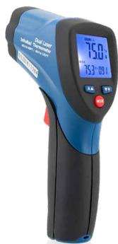
IRT2是一种手持式、双激光器、非接触式红外测温仪，具有12: 1的距离与光点比和可听和可见的高/低设定点报警。它用于测量和显示-50°C至650°C (-58°F 至1202°F ) 范围内的表面温度，其精度约为1至1.5% (详见规范)。IRT2具有快速响应时间 (0.15秒)，采用9V电池供电，符合II级英国/欧盟激光安全标准EN60285。
