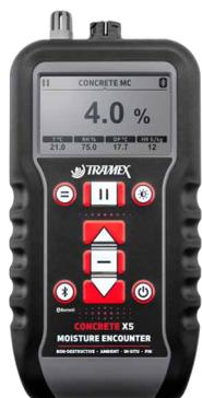
Tramex CMEX5混凝土含水率测试仪是一种无损的数字多湿度计，以重量测试为基准，提供即时和精确的定量测量混凝土的水分含量。CMEX5包含一个内置的湿度计和插件端口，用于相对湿度探针和屋面材料的针式探针测试。
