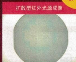
通过1200nm波长的光源作背光对晶圆进行检测
