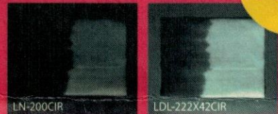
通过1450nm的波段对海绵中水分含量的检测
