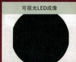
通过1200nm波长的光源作背光对晶圆进行检测
