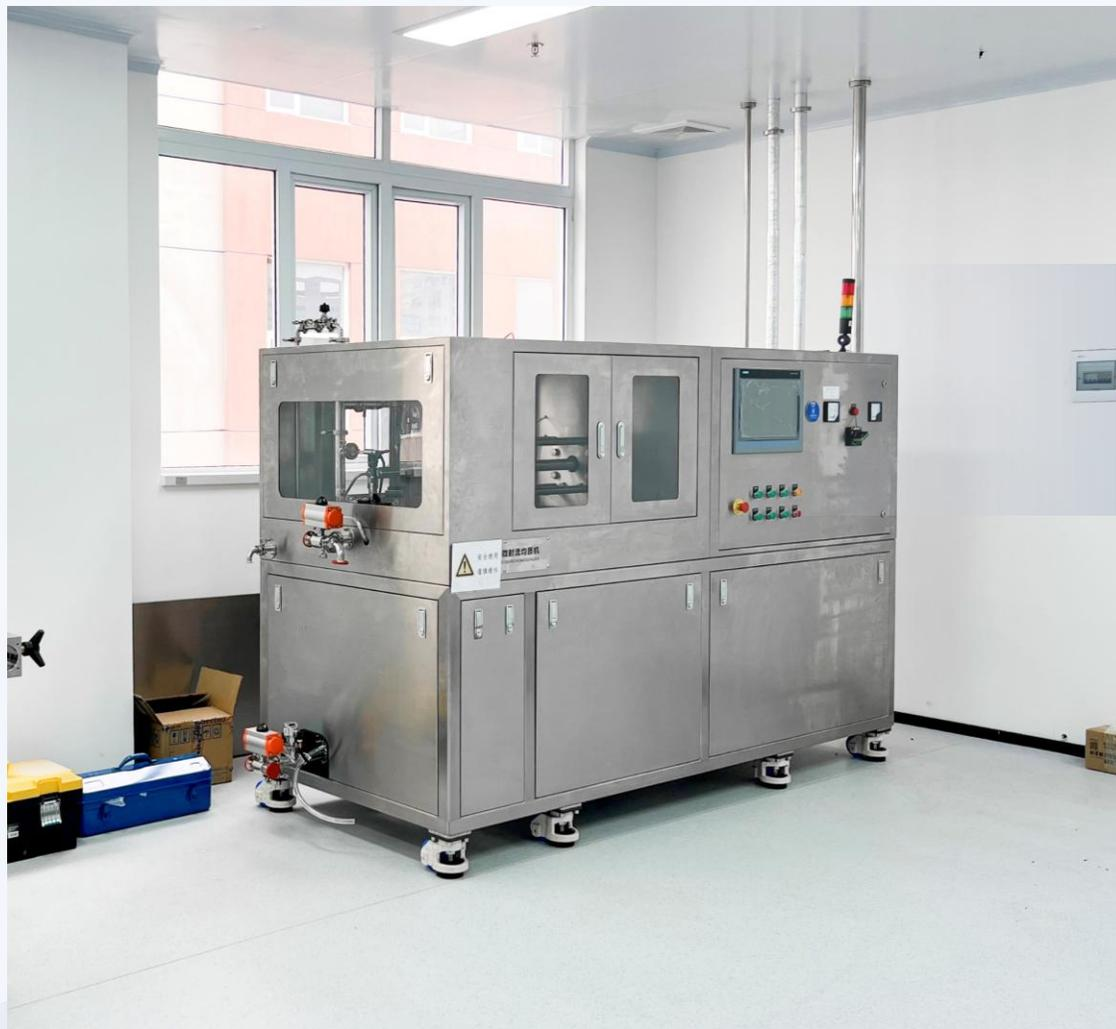
清远某企业，新建生物美容化妆品及原料生产线，采购中试型DNH-2000，进行产品研发、测试。用于冻干粉、精华液、修复霜等产品的生产加工。
