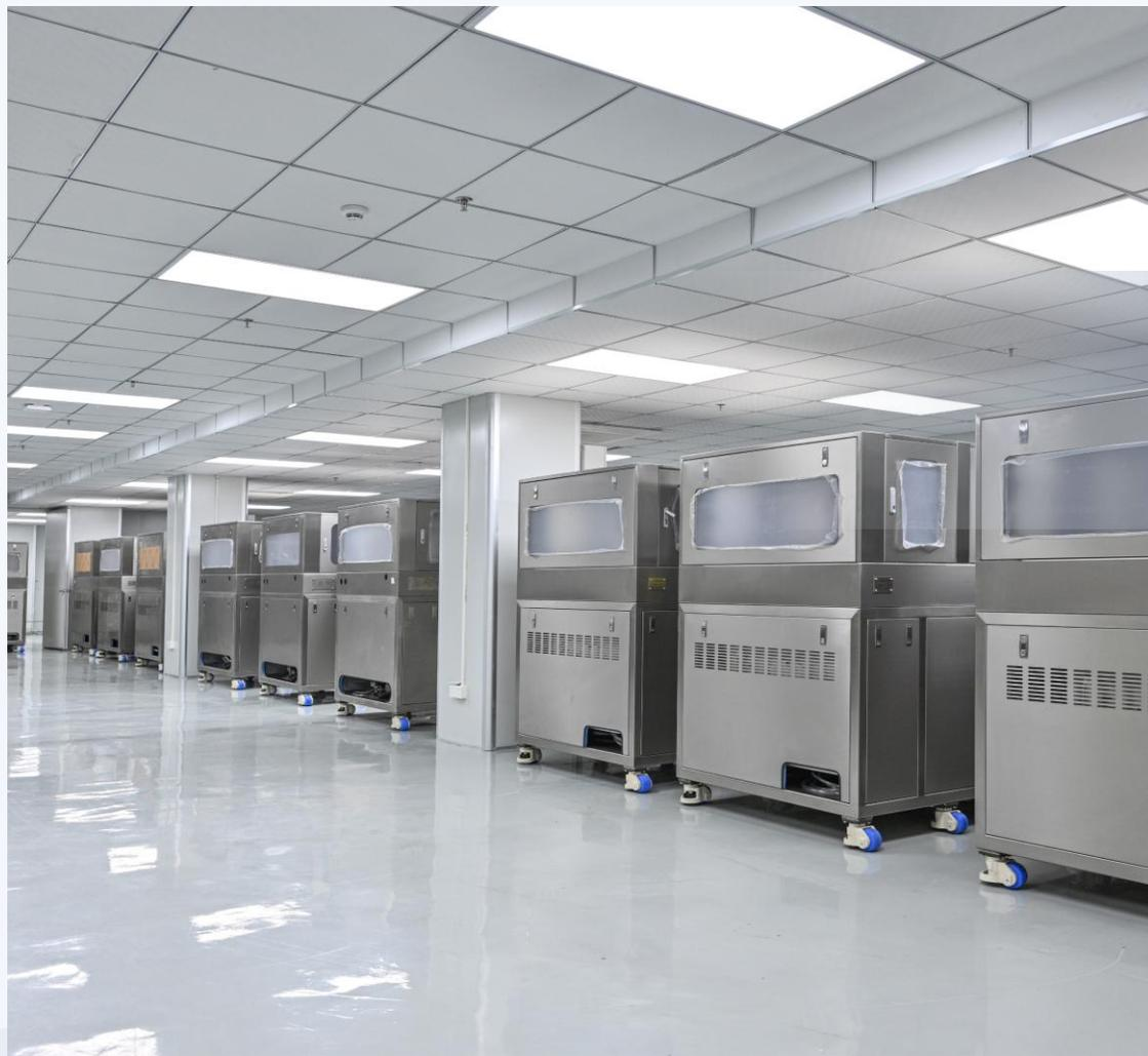
国家石墨烯创新中心，采购12台量产型DNH-8000，用于批量处理石墨烯材料，在更短的时间内实现石墨的高效氧化和石墨烯的剥离，提高石墨烯的质量和产量，同时降低生产成本和环境风险。
