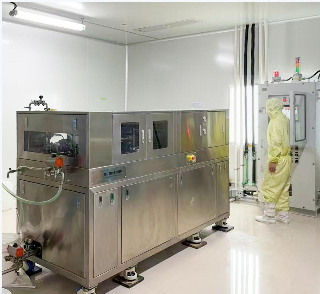
某电子材料企业，新建高端陶瓷电容生产线，采购量产防爆型DNH-4000-Ex，进行电极材料及电子浆料生产加工。
