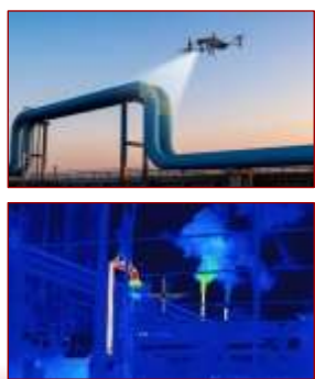
图3 气体泄漏快速巡检
