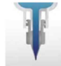
前端有抛光处理在 15,000 次点胶后未发现爬胶现象 前端无抛光处理在 5,000 次点胶后会出现爬胶现象
