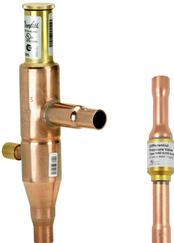
由 KVR 和 NRD 组成的调节系统用于在采用风冷冷凝器的制冷和空调设备中保持恒定较高的冷凝器和储液器压力。
