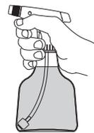
④ノズルを回して霧の角度が調節できます。
