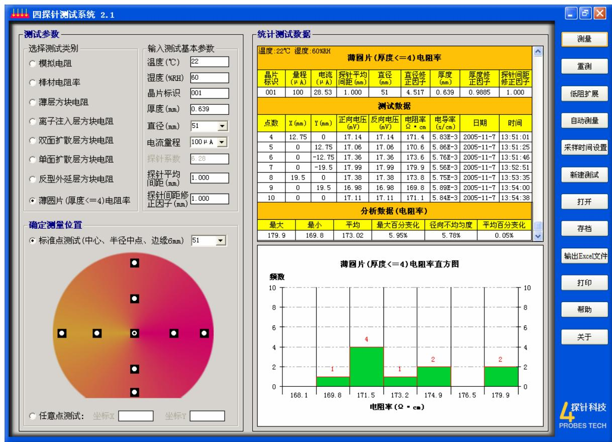
RTS-8 型四探针软件测试系统是一个运行在计算机上拥有友好测试界面的用户程序,通过此测试程序辅助使用户简便地进行各项测试及获得测试数据并对测试数据进行统计分析。
