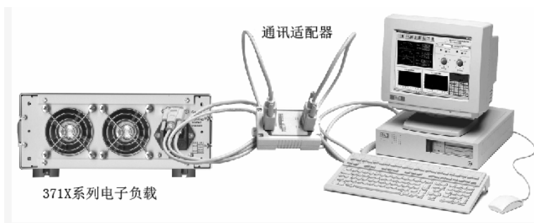
图1-1 连接电子负载和计算机
