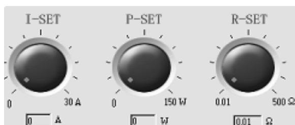
图2-7旋钮设置电流，功率，电阻
