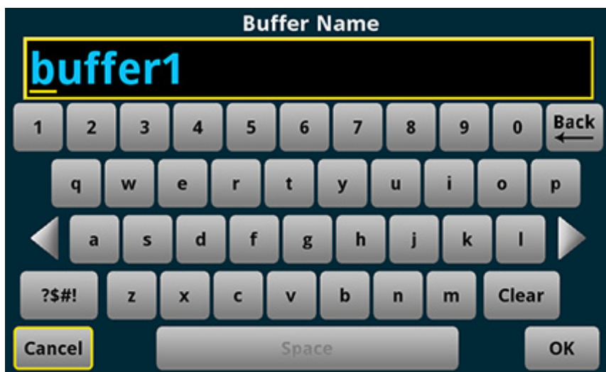
图 3：用于输入信息的 DMM6500 前面板键盘
