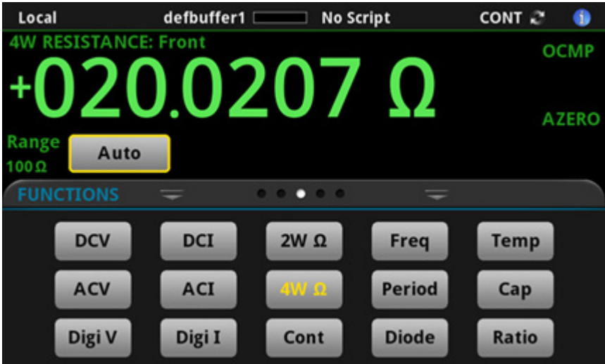
图 37：4 线电阻测试结果
